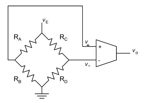
Raison d'être: convert tiny changes in resistance to voltage.
