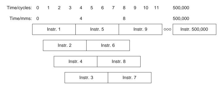
IC = 500,000;  $\phi = 200 \,\text{kHz};$  CPI = 1.
